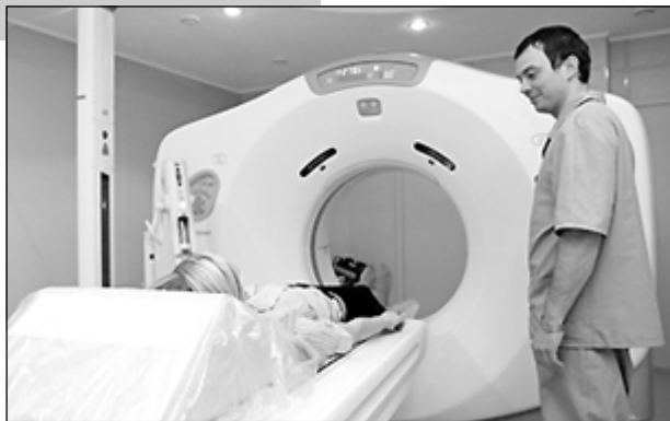
Мультисрезовой компьютерный томограф поступил в онкодиспансер в рамках целевой федеральной программы по оснащению онкологическим оборудованием. Он позволяет выявить очаговые образования в тканях и органах, уточнить их размеры и взаимосвязь с органами и сосудами, что позволяет планировать правильное лечение больного.
