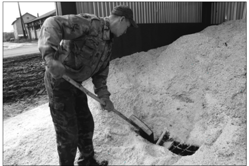
Узким местом в котельных, работающих на опиле, является подающий транспортер. Для просеивания опила без лопаты не обойтись.
